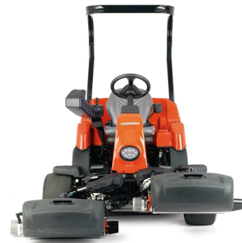
Die Mäheinheiten sind einzeln und unabhängig voneinander aushebbar
